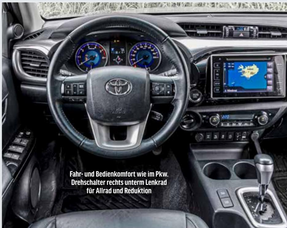
Fahr- und Bedienkomfort wie im Pkw. Drehschalter rechts unterm Lenkrad für Allrad und Reduktion
